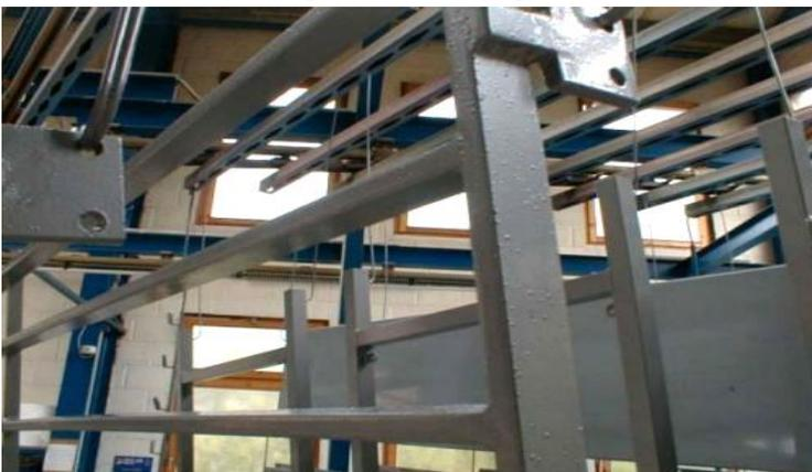
Abb. 36: feuerverzinkte Ware nach der Bearbeitung (Futronika, 2022)
