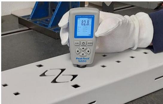
Abb. 35.1 und 35.2: Schichtdickenmessung Zelenka (Futronika, 2022)
